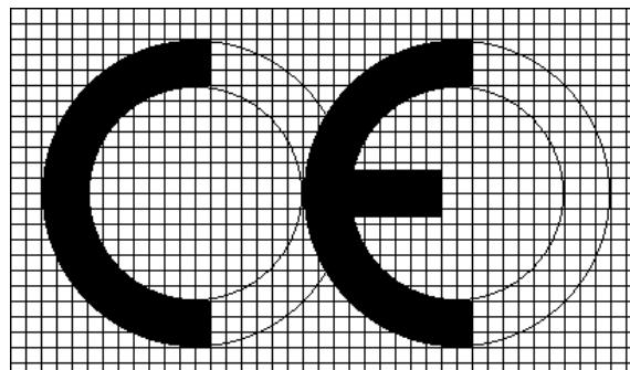
Σε περίπτωση σημίκρυνσης ή μεγέθυνσης, πρέπει να τηρούνται οι αναλογίες του ανωτέρω διαβαθμισμένου σχεδίου.
